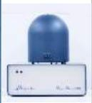
재료의 공명 완화 시간을 측정하여 입자 계면 상태 및 분산 응집 상태 등 재료 평가에 사용 가능. 유변특성 및 계면 특성 등에 의한 시료 차별화가 어려운 경우 상대적으로 누구나 쉽게 빠르게 재현성 좋은 데이터를 취득 가능. 작고 가벼워 최소의 공간에서 운영 가능 하며 고농도 분산계로 희석하지 않고 원액 상태에서 측정 가능
