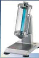
Höppler 점도계로 알려진 전통의 독일 HAAKE Falling Ball Viscometer Type-C는 기체 및 투명한 Newtonian 유체의 점도측정에 적합하며 점도 0.5~10E+05mPas / 온도 -20 ~120°C 영역에서 사용 가능합니다.
