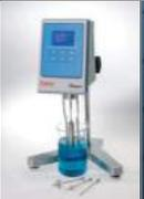
21개의 Rotatioin speed 를 선택하여 Newtonian 및 Non-Newtonian 유체용 상대 점도 결정을 위한 독일산 HAAKE 점도계입니다. USB를 통해 PC로 Data transfer가 가능합니다.
