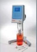
54개의 Rotatioin speed 를 선택하여 Newtonian 및 Non-Newtonian 유체용 상대 점도 결정을 위한 독일산 HAAKE 점도계입니다. 소프트웨어를 통한 시험 및 분석이 가능합니다.
