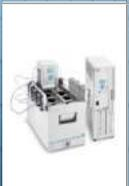
"Fogging Tester System" 이란 일부 물질에 내재 된 Out - Gassing (배출 가능 가스)량을 측정하기 위하여 고안된 실험법으로써 자동차 내장재의 일부로 광범위하게 사용되는 연질PVC, 직물 및 가죽의 휘발성분의 증발현상을 측정하기 위한 실험법이며, 주로 자동차 관련 산업에서 사용되어지고 있습니다.
